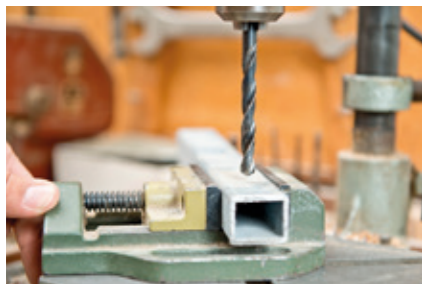
2 Maschinenschraubstock fixiert Werkstück
