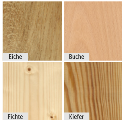
1 Der Wachstum der Holzfasern bestimmt die Maserung von Holz.
